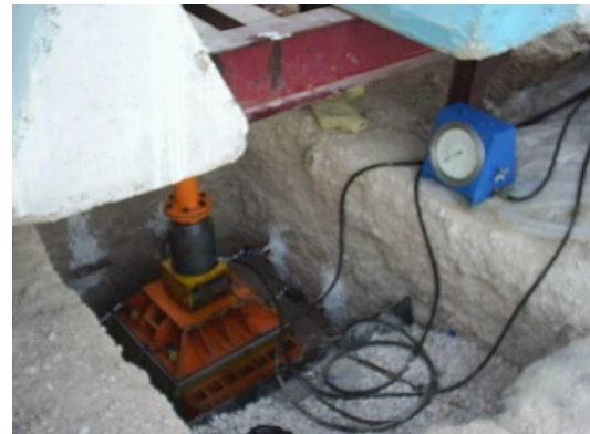
آزمایش‌های بارگذاری صفحه‌ای و برش مستقیم برج‌ها به ترتیب - منطقه عسلویه و پروژه راه آهن ساسان-شبنم
