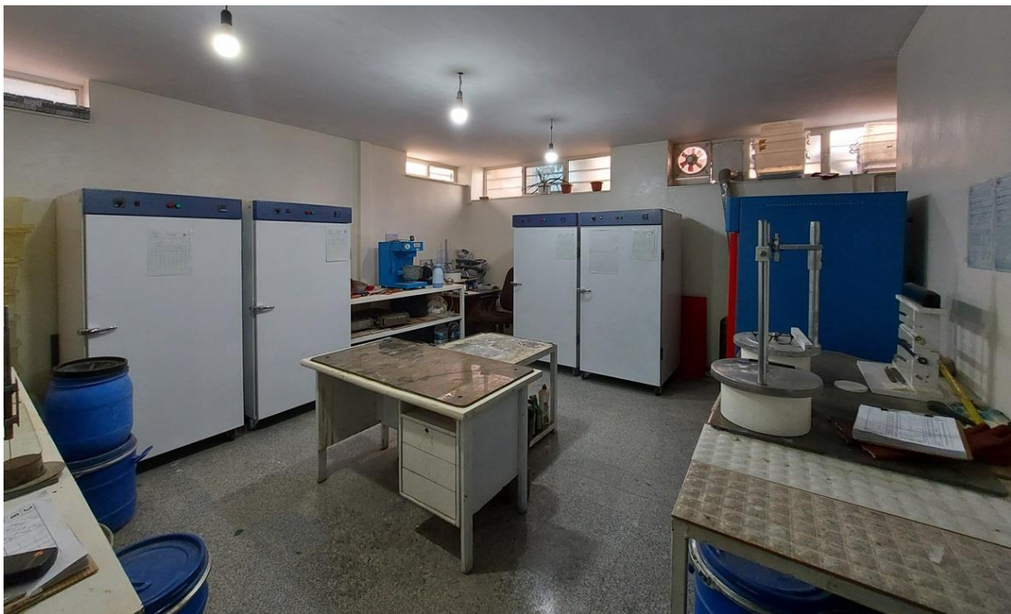
آزمایشگاه تکنولوژی بتن برای آزمایش در دمای طولانی مدت با انکوباتور
