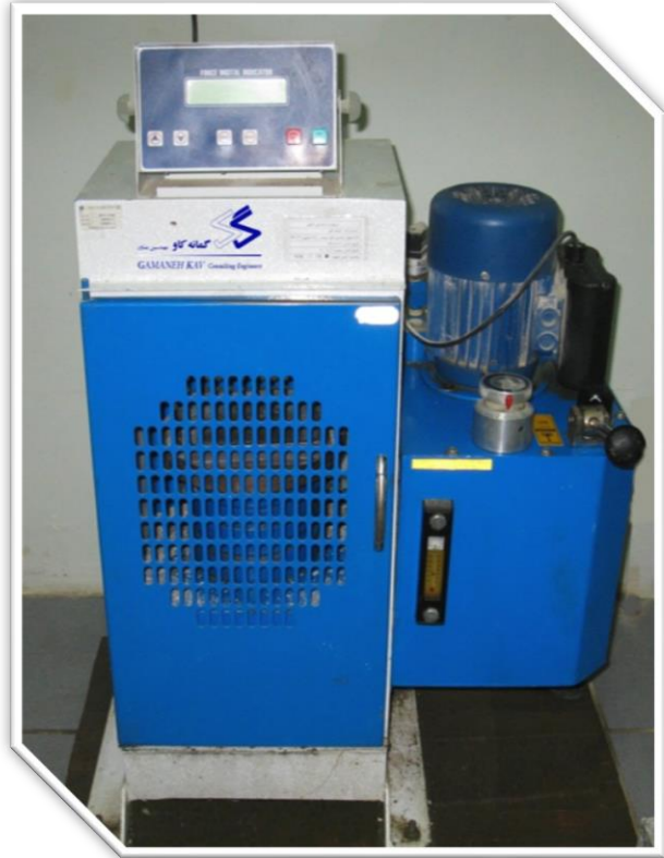
جک بتن شکن و دستگاه آزمایش کشش میلگرد
