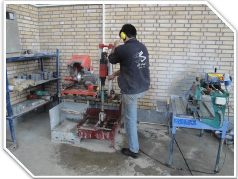
تجهیزات آماده سازی نمونه و نصب جابجایی سنج بر روی نمونه سنگی
