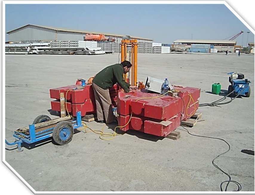
انجام آزمایش CPTU - پروژه جرثقیل دروازه‌ای ۱۰۰۰ تنی صدرا- بوشهر
