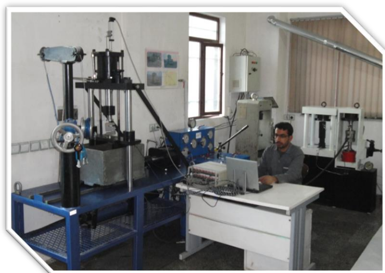
نمونه آزمایش و دستگاه برش مستقیم تمام هیدرولیک با سیستم سروو کنترل
