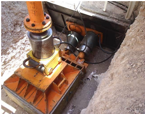
آزمایش‌های بارگذاری صفحه‌ای و برش مستقیم برج‌ها به ترتیب - منطقه عسلویه و پروژه راه آهن ساسان-شبنم
