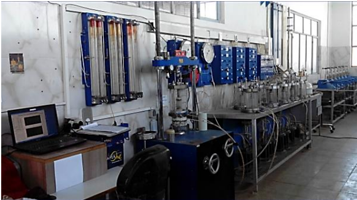
آزمایشگاه مرکزی خاک و تجهیزات آزمایش سه محوری خاک
