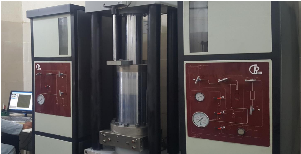
دستگاه آزمایش سه محوری سنگ با سیستم سروو کنترل برای فشارهای همه جانبه تا ۷۰۰ بار و دمای تا ۱۵۰ درجه سانتی گراد
