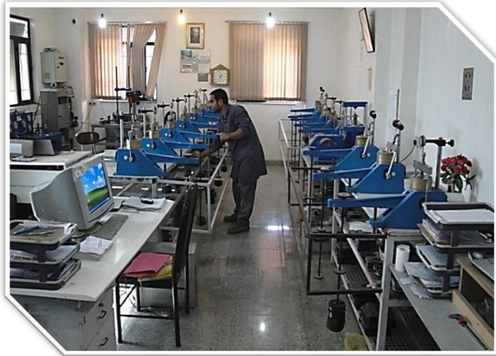
آزمایشگاه مرکزی خاک و تجهیزات آزمایش تحکیم خاک
