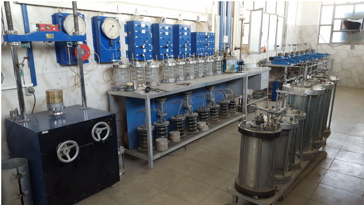
سیستم بارگذاری آزمایش سه محوری خاک و سلولهای بزرگ ۶ و ۹ اینچی
