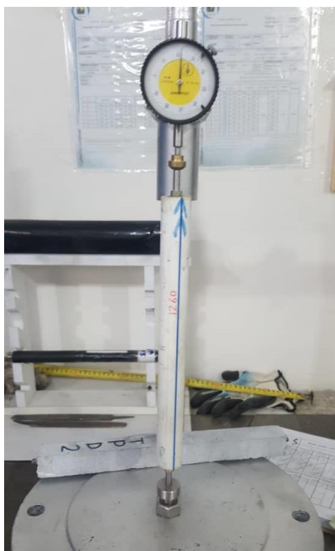
ژرminatور، نمونه‌های با ابعاد و اندازه استاندارد و کومپراتور اندازه گیری تغییرات
