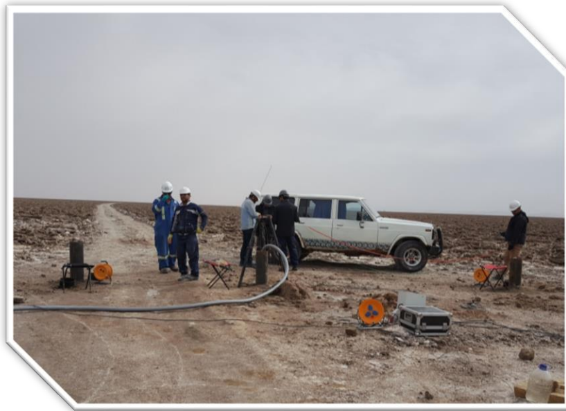
آزمایش پمپاژ - پروژه اکتشافی دریاچه نمک قم
