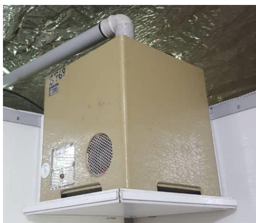
رطوبت ساز و ظروف مخصوص نگهداری نمونه بتنی در شرایط رطوبت و دمای خاص
