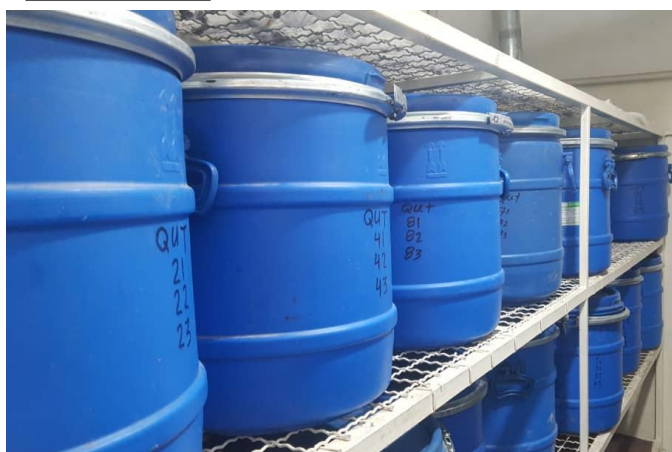
رطوبت ساز و ظروف مخصوص نگهداری نمونه بتنی در شرایط رطوبت و دمای خاص
