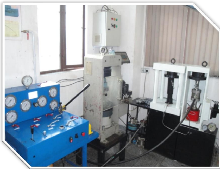
نمونه آزمایش و دستگاه آزمایش شکست هیدرولیکی آزمایشگاهی
