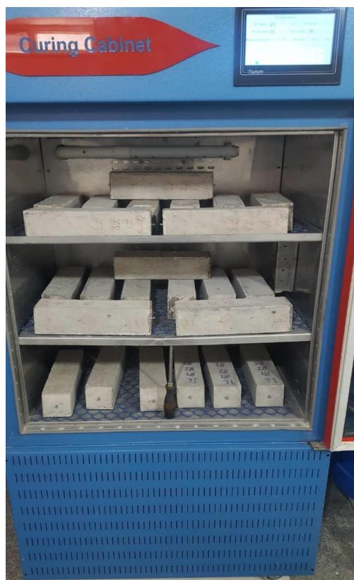
ژرminatور، نمونه‌های با ابعاد و اندازه استاندارد و کومپراتور اندازه گیری تغییرات
