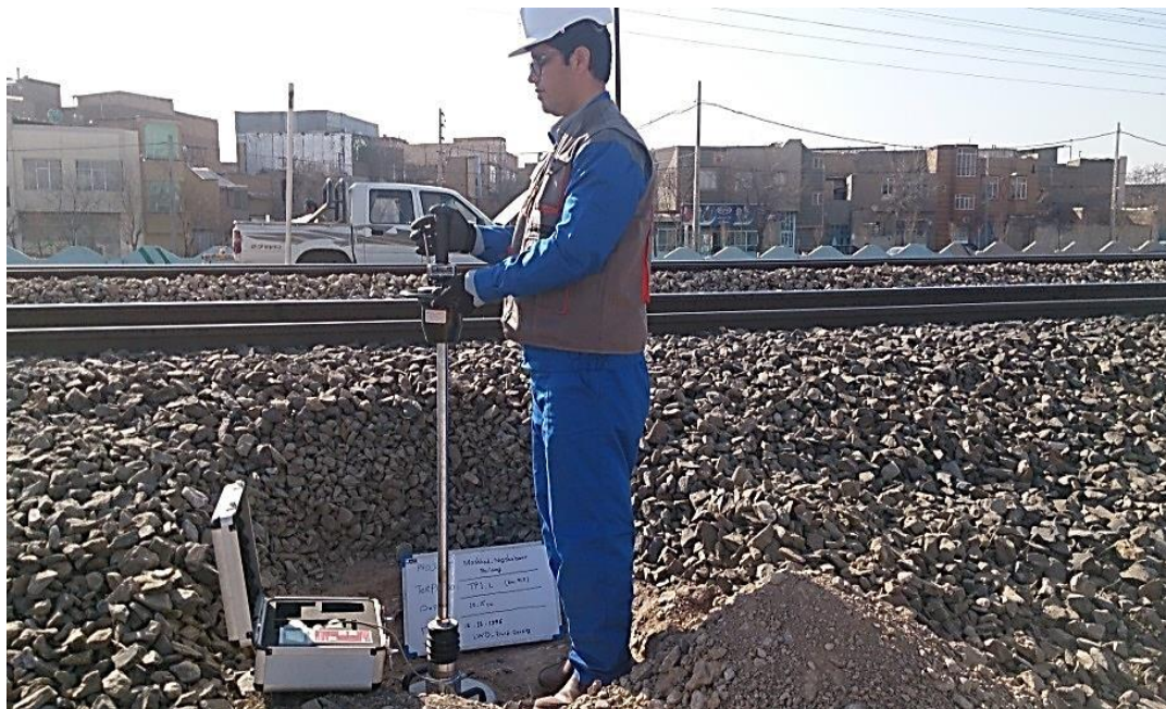
آزمایش بارگذاری صفحه ای دینامیکی (LWD) - پروژه قطار سریع السیر تهران-مشهد
